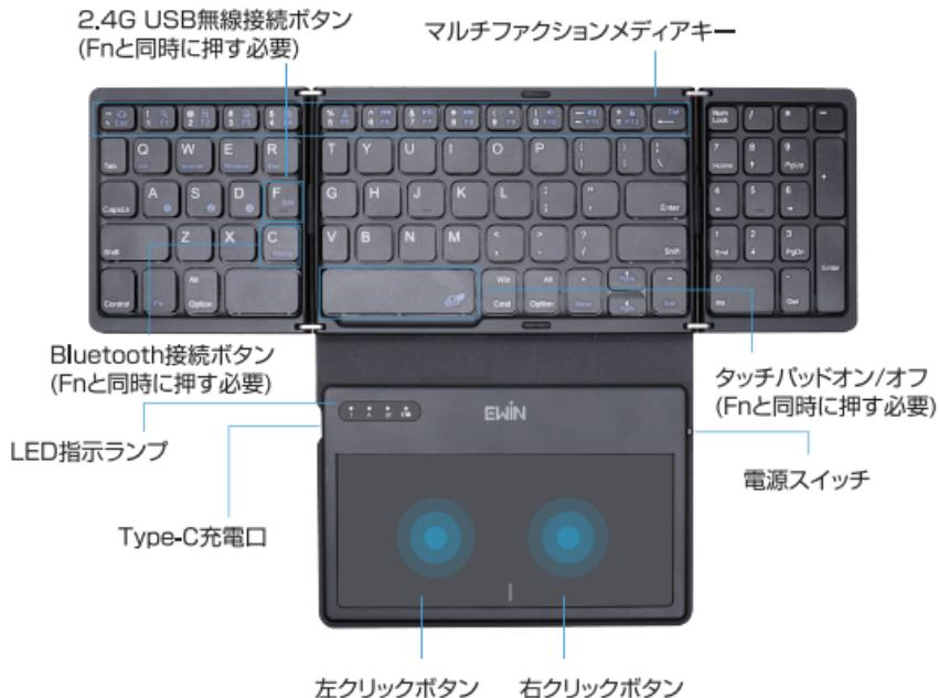
Fn+C(Pairing)でキーボードをBluetoothペアリングモードにし、Fn+2.4Gで2.4G USB無線接続モードにします。
