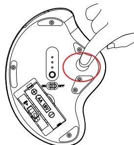
2.綿棒などでボールの接触面三ヶ所にたまっているホコリを取り除きます。
